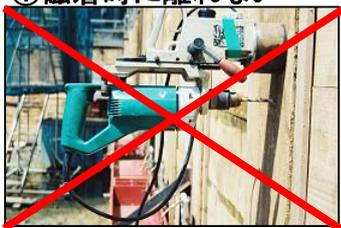
アトラマスターをH鋼に磁着した状態で両手を離したり、場を離れたりしないこと。万が一電力が落ちた場合、磁着が外れて落下すると他者の怪我や機械の損傷の原因となる。
